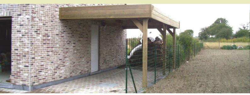
**Descriptif** : Structure en Pin sylvestre • Traitement autoclave • Poteaux 12 x 12 • Fermes massives • Pannes 45 x 145 mm • **Platines réglables** • Modèles à toiture en 2 pans : sous-toiture massive 17 x 95 mm et couverture en shingles noirs • Modèles à toiture plate : couverture en tôles ondulées.
